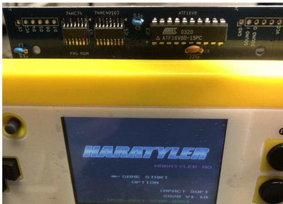
以上の手順でまず FC 側基板がタイトル画面まで起動出来る事を確認してから MP3 拡張ユニットの作成をしてください。FC 側基板が起動出来ない場合は、半田付けの実装不良がないか、部品を逆向きに付けていないか？などを確認して下さい。
